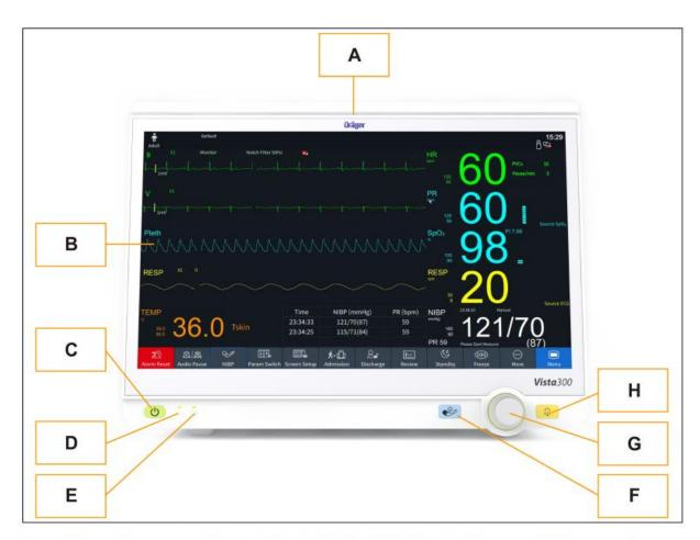
A Indicador de alarma Cuando se activa una alarma, el indicador de alarma se ilumina o parpadea. El nivel de alarma está codificado por colores. Alarma de nivel alto: parpadea en rojo; alarma de nivel medio: parpadea en amarillo; alarma de nivel bajo: constantemente en amarillo para alarmas fisiológicas y constantemente en cian para alarmas técnicas.
